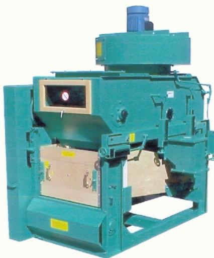
**Der Reiniger Typ GS wird für die Feinreinigung von Getreide, Öl- und Hülsenfrüchten sowie für Blumen- und Gemüsesamen eingesetzt, wo kleinere Mengen zu verarbeiten sind**
