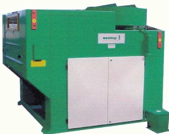
**Der Strohabscheider Typ HG ist ein effektiver Vorreiniger aus dem Modulprogramm, der als Einzelmaschine eingesetzt werden kann**
